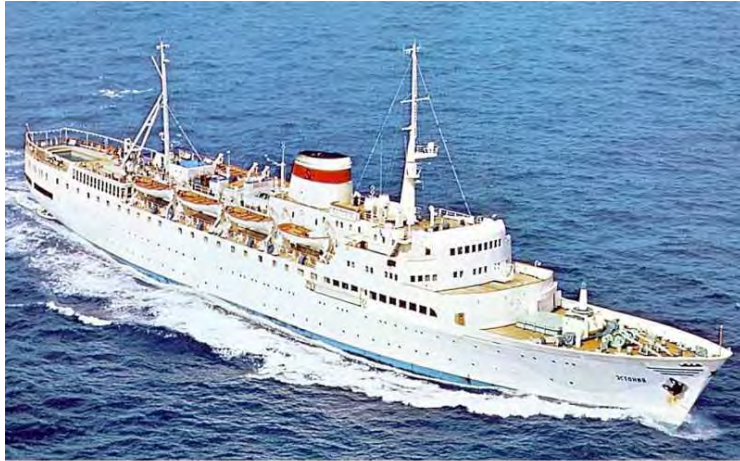
Пассажирское судно «Эстония», построено в 1960 году на верфи г Висмар, ГДР. Длина - 122 м, ширина - 16 м, высота борта - 7,6 м, осадка - 5,25 м, 2 дизеля MAN-DMR, мощность 8300 л.с., скорость 16,5-18 узл., 350 пассажиров, 134 чел. экипаж. Разрезано в 2003г. 23.09-07.10.1962г из Балтийска в Гавану доставило 400-й ОМСП Язова Д.Т. 27.05-10.06.1964г из Гаваны в Ленинград доставило Штаб и Техдивизион 16-го зрп 12-й дПВО ГСВК (Моя каюта 230, место 1, лев. борт, корм. часть, ниж. палуба) (альбом Дмитриева А.А.) http://mmflot.com/forum/gallery/image_page.php?album_id=16&image_id=2928
